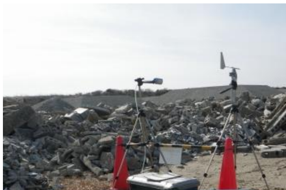
石綿大気濃度調査の例(仮置場)
